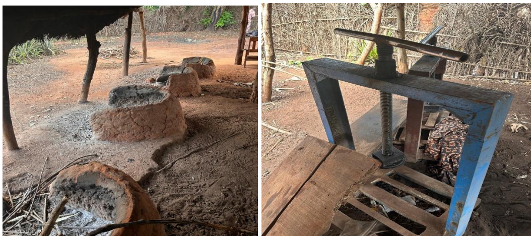
Clichet 2 : Fours et la presse utilisés au cours de la transformation du manioc à Comé
